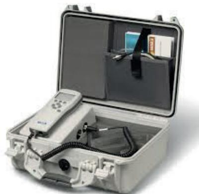
**Kit de contrôle VAISALA PTB330TS dans sa mallette de transport**
